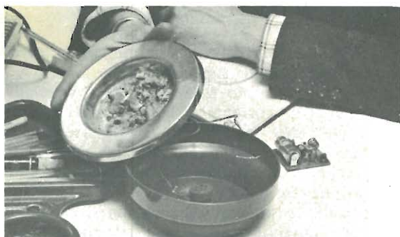
La piccolissima capsula microfonica si presenta per essere nascosta con la massima facilità, ad esempio nell'interno di un posacenere.
