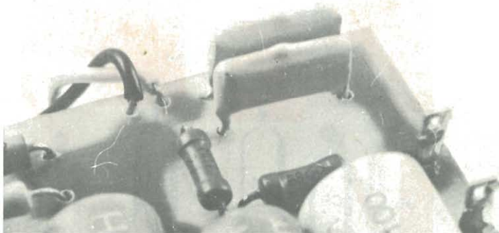
I due condensatori (in alto sulla basetta) vengono inseriti e disattivati con il deviatore cambiando il punto di lavoro del filtro.
